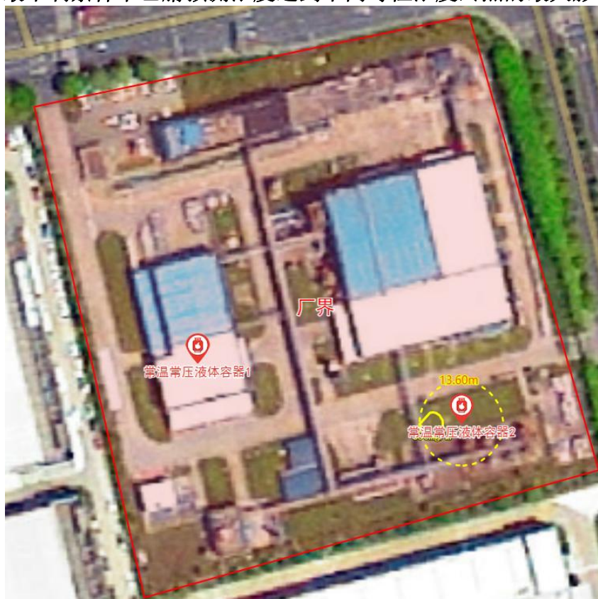
图 5.2-4 最不利条件下碳酸二乙酯预测浓度达到不同毒性浓度终点的最大影响范围图
