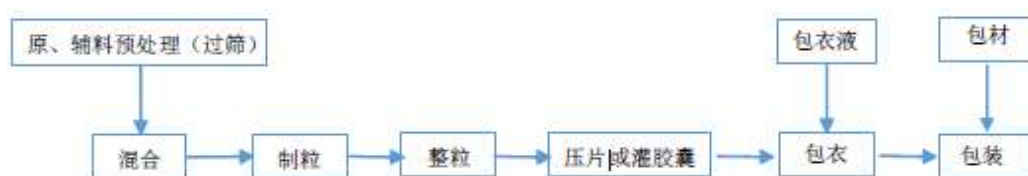
图 1-9 制剂和分析实验室—固体制剂开发工艺流程图
